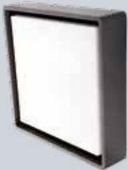
**Wandleuchte** – graphit, Aluminiumdruckguss pulverbeschichtet, Polycarbonat, schlagfest (IK10), UV-beständig, B. 240 mm, H. 240 mm, Ausl. 77 mm, 7 W, 500-700 lm, 3000 K, 5 Jahre System-/10 Jahre Korrosionsschutzgarantie
