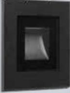
**Wandeinbauleuchte** – schwarz, Polycarbonat, Glas, schlagfest (IK07), schaltbar, L. 75 mm, B. 75 mm, Ausl. 5 mm, Einbautiefe 45 mm, 1,4 W, 35 lm, 3000 K
